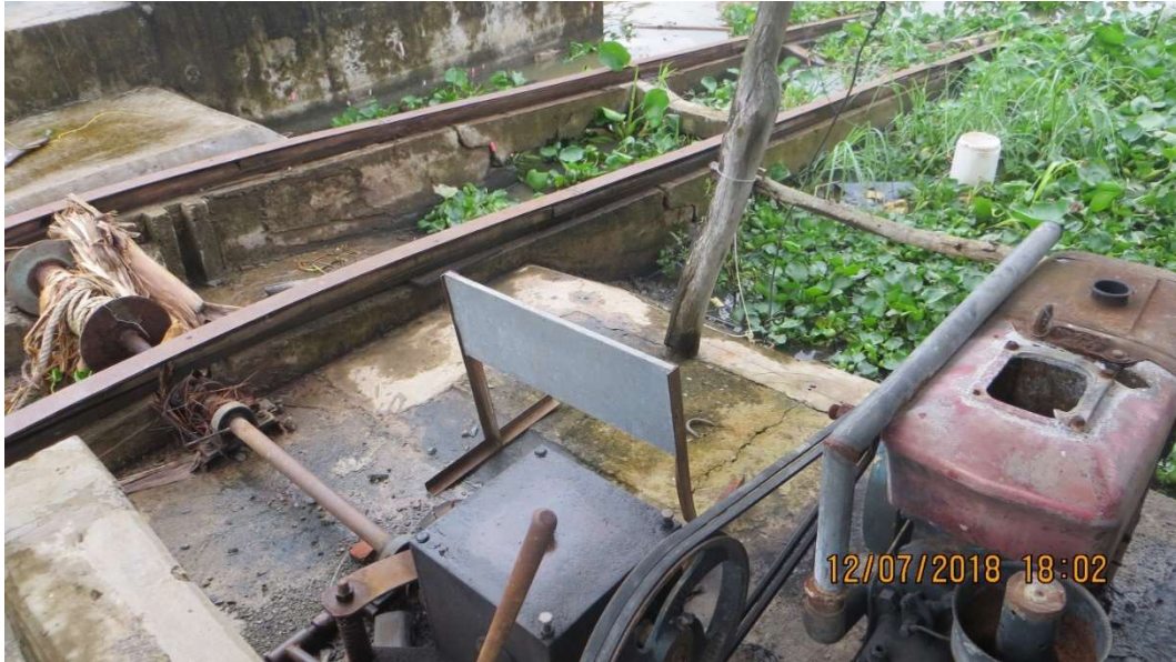
Ảnh 11: Hệ thống tời kéo vỏ lõi qua cổng Nàng Rền, nhưng rất ít hoạt động (ảnh chụp ngày 12/7/2018, Lê Anh Tuấn)
