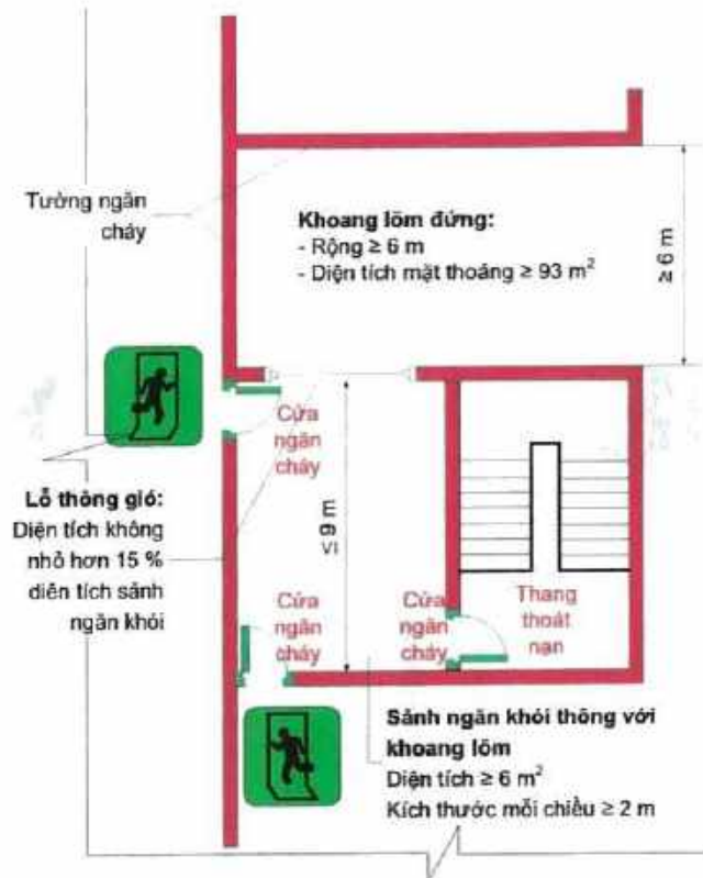
e) Khoảng đệm không nhiễm khói là một sảnh có thông gió tự nhiên với khoang lôm
